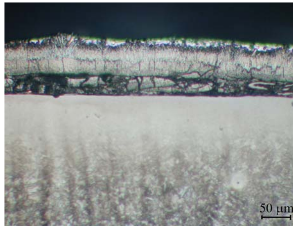
Obr. 12 - Primární delaminace povlaku
