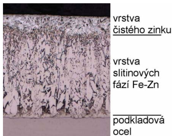
Obr. 6 - Povlak na oceli uklidněné křemíkem
