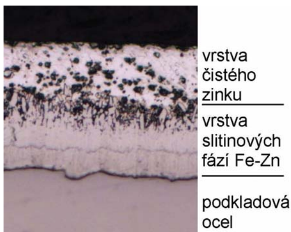
Obr. 5 - Povlak na oceli neuklidněné křemíkem
