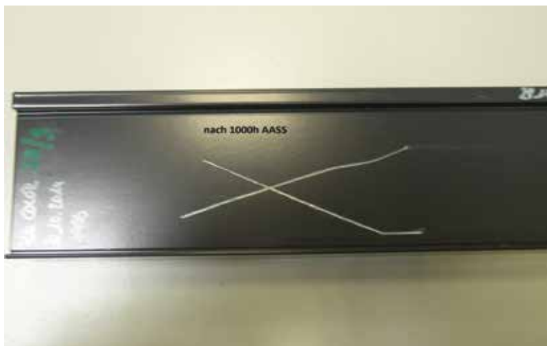
Obr. 2 - ALU-COLOR s.r.o.- výsledek po expozici Al profilu 1000 h v okyselené solné mlze dle ISO 9227 AASS, podkorodování, delaminace 0 mm, puchýře 0 (S0)
