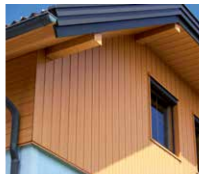
Obr. 1 - Zavěšený hliníkový provětrávaný fasádní systém Prefa Sidings lze montovat jak svisle, tak vodorovně ve třech různých šířkách (138, 200 a 300 mm) s příznanou nebo nepřiznanou spárou. Povrchová úprava stucco, hladká nebo linkovaná.
