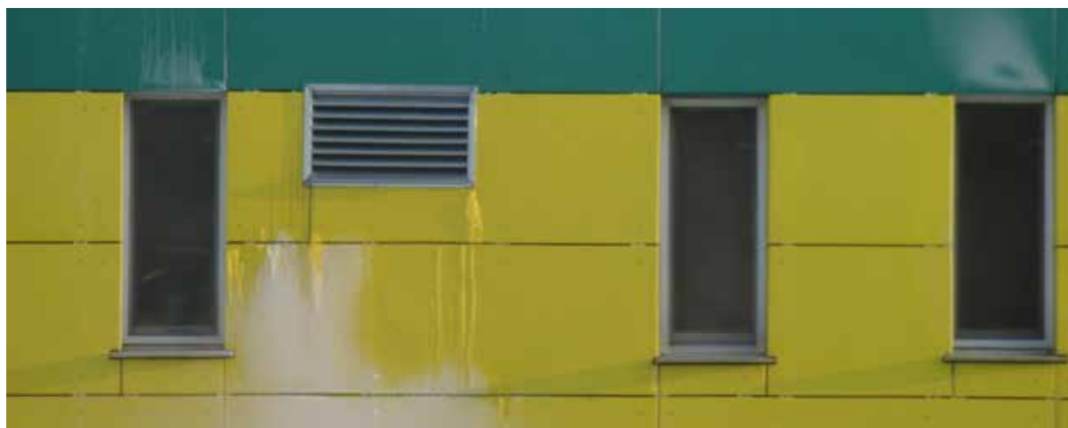
Obr. 1 - Vliv reálné expozice na fasádní desky - testovací fasáda v areálu závodu Cetris, stav leden 2017, vlivem nízkých teplot je silná námraza při konzistenci vlhkosti na povrchu fasádních desek
