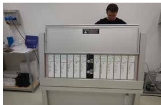
Obr. 3 - Testování vzorků desek Cetris v QUV komoře
