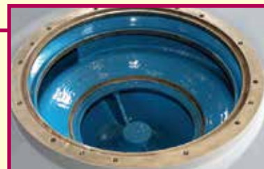
Potah vnitřní části odstředivého čerpadla
