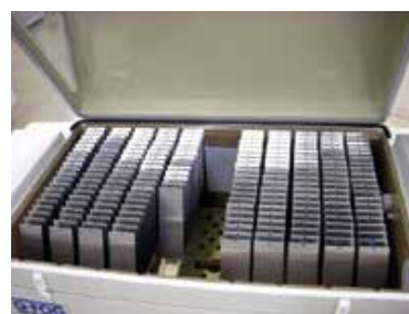
Obr. 4 - Korozní panely v komoře Q-FOG CCT 600
