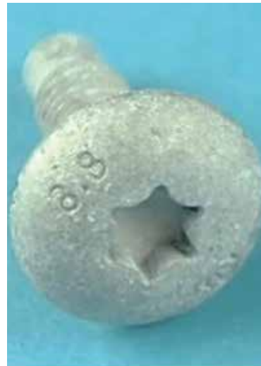
Obr. 3 - Dílec s topcoatem Techseal Silver SL po korozním namáhání 1000h v neutrální solné mlze
