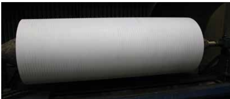
Obr. 2 - Renovace válce zinkovací linky vysokorychlostním nástřikem HVOF zařízením TAFA JP 5000
