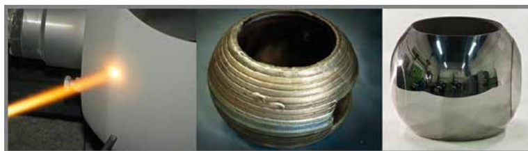
Obr. 3 - Proces renovace koulí
