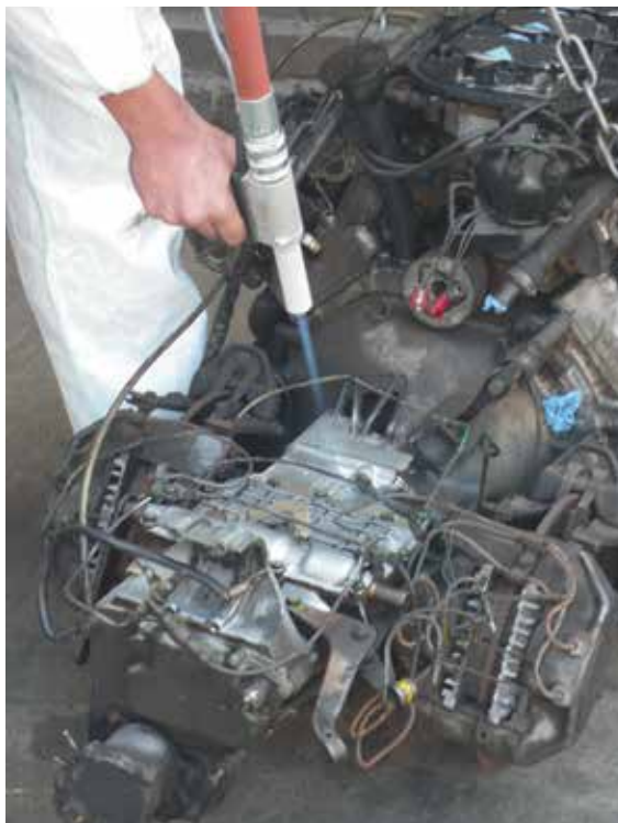
Obr. 4 - Technologie tryskání suchým ledem v praxi
