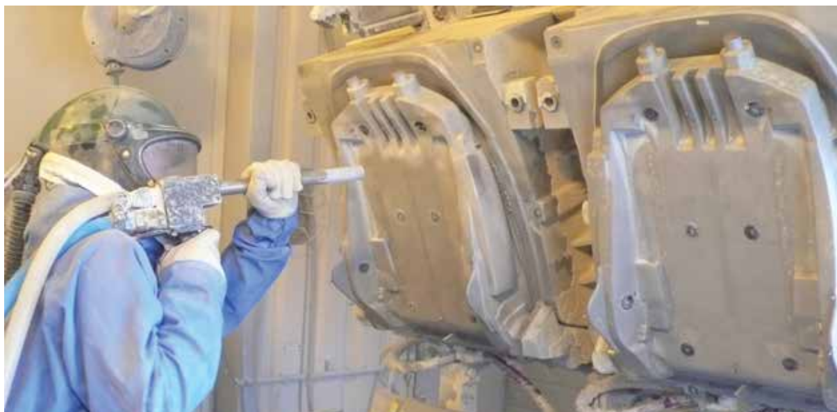
Obr. 5 - Tryskání suchým ledem ve výrobním procesu
