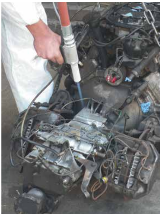
Obr. 4 - Technologie tryskání suchým ledem v praxi
