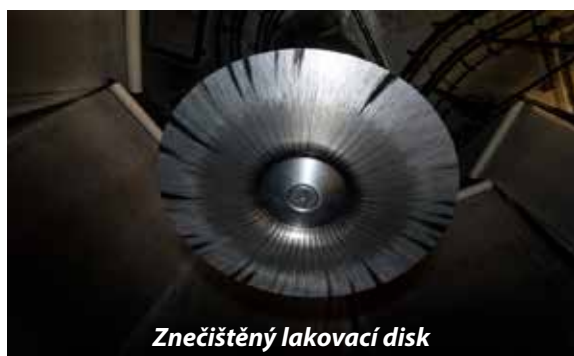
Obr. 3 - Znečištěný lakovací disk před a po očištění vodou
