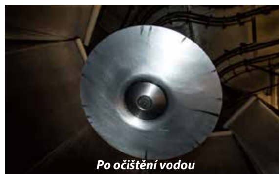
Obr. 3 - Znečištěný lakovací disk před a po očištění vodou
