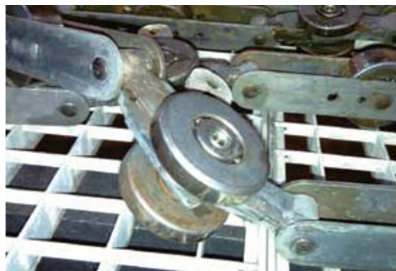
Obr. 4 - Řetěz dopravníku po vyčištění
