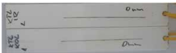
Obr. 5 - Zkušební dílce z ČR (Fe profily) se SurTec 609 EC lakované KTL barvou po korozním namáhání 1000 h v neutrální solné mlze dle ISO 9227: Stupeň podkorodování Ri 0, bez puchýřů
