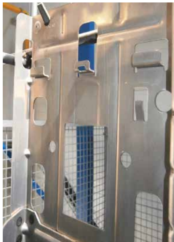
Obr. 4 - Typicky zlatavá barva konverzní pasivace povlaku SurTec 609 EC, z provozu v ČR
