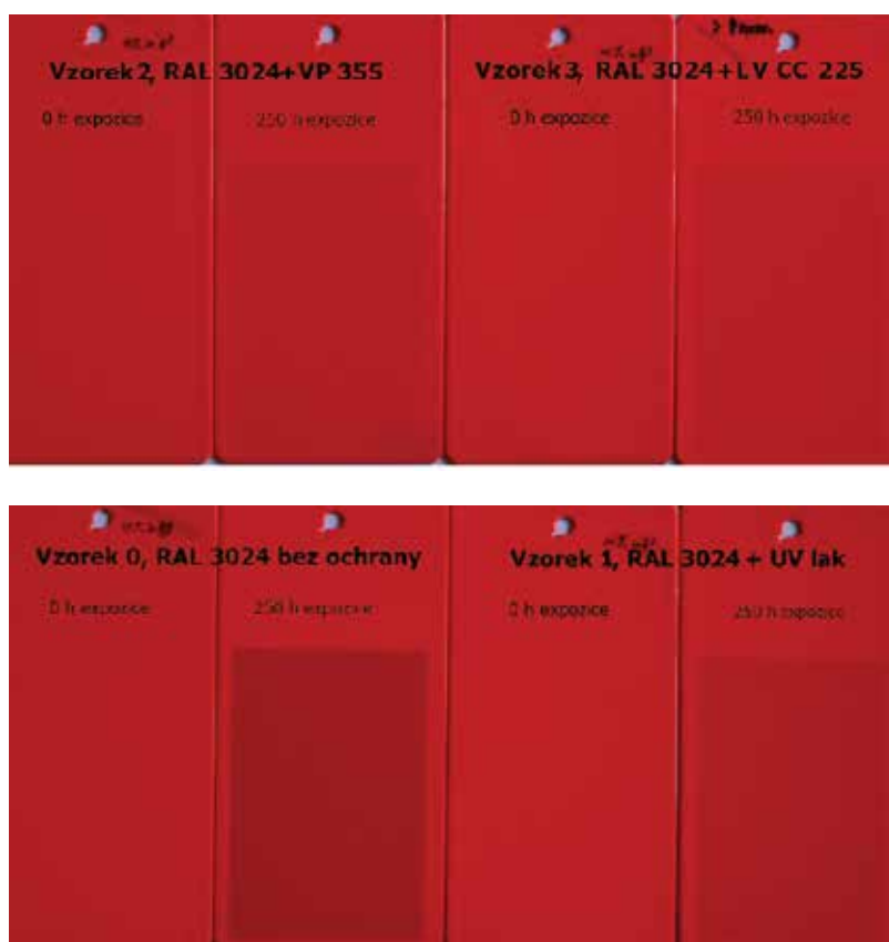
Obr. 5 - Vizuelní porovnání nátěrového filmu jednotlivých vzorků před a po expozici (250 h) v QUV panelu
