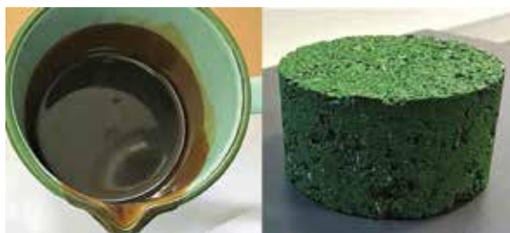
Obr. 2 - Detail barvy pojiva a válcového zkušebního tělesa (zdroj: TPA Spoločnosť pre zabezpečenie kvality a inovácie, s. r. o.)
