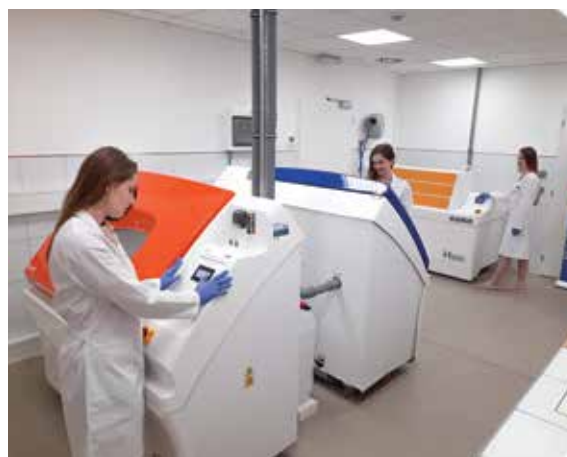
Obr. 4 – Solné a kondenzační komory
