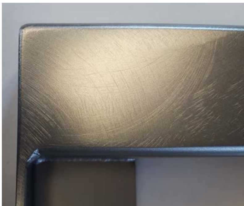
Obr. 6 - Stopy po broušení jsou viditelné i po otryskání
