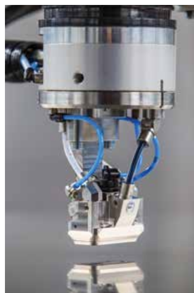
Obr. 1 - Aplikátor EcoPaintJet zvýší účinnost lakování a poskytuje výrobcům více možností pokud jde o vzhled výrobku
