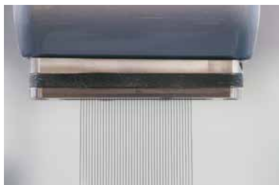
Obr. 3 - Lakování bez přestříků: EcoPaintJet aplikuje tenké paralelní pruhy barvy za využití tryskové destičky
