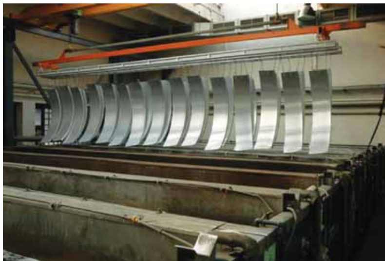
Obr. 3. Chemická předúprava dílů ve společnosti PULCO, a.s.
