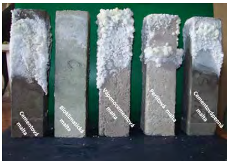
Obr. 2 - Zkušební tělesa po zkoušce odolnosti proti solím v modelovém roztoku podle WTA
