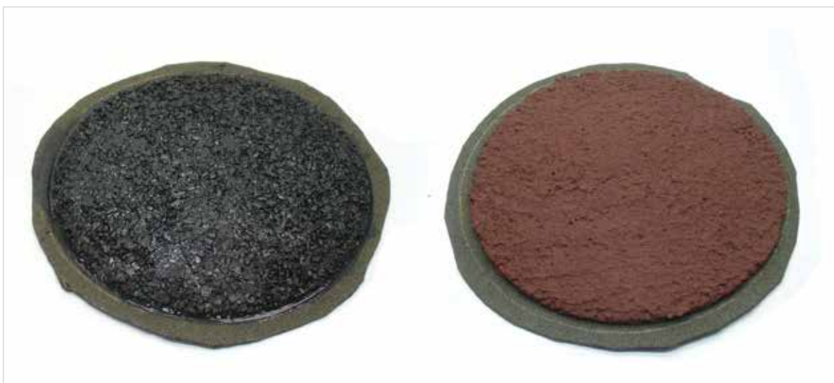
Obr. 3 - Vzorky kalových zákrytů, vlevo nebarven, vpravo 8,2% Fepren TP200
