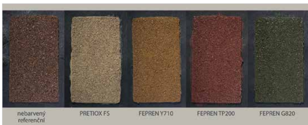
Obr. 2 - Příklady asfaltů s transparentními pojivy
