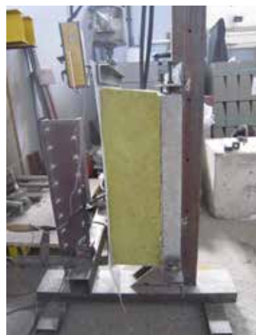
Obr. 10 - Deformace vzorku mechanicky kotveného ETICS s TR10 před porušením
