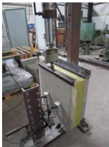
Obr. 7 - Uspořádání zkoušky smykové pevnosti ETICS
