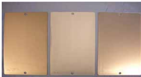
Obr. 1 – Díly předupravené pomocí zirkoničité pasivní vrstvy (zleva: ocel, galv. pozink. ocel, hliník). Tato vrstva je rozpoznatelná nazlátlým zbarvením
