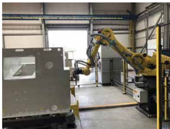
Obr. 2 – Robotická bruska s výměnnou brusnou hlavou na předúpravu konstrukcí
