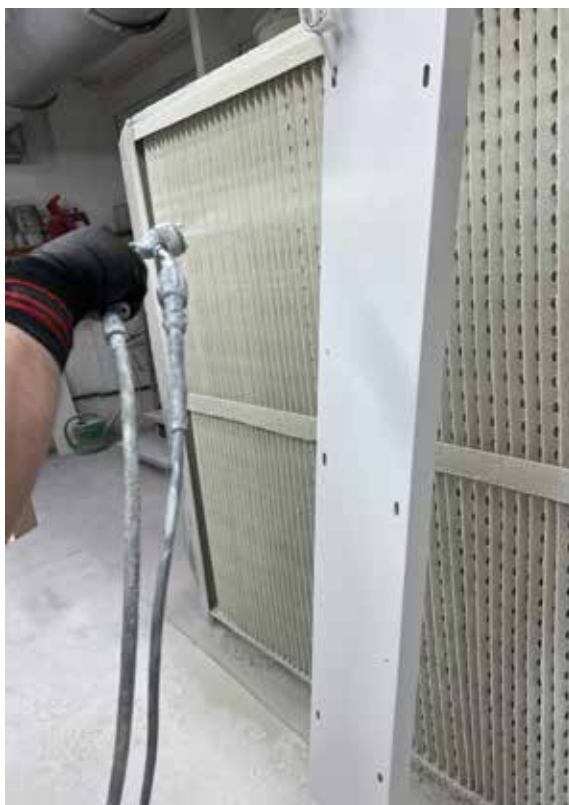
Obr. 3 – Lakování části schodiště
