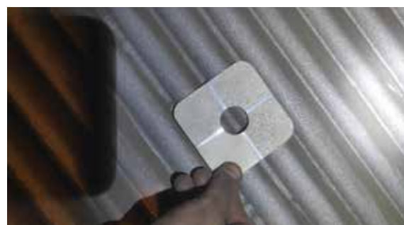
Obr. 9 – Mezioperační kontrola plochy po trysku na dosažení požadované jakosti povrchu (čistota a povrchová drsnost)
