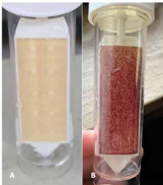
Obr. 1 – Test biologické kontaminace vody (A – před testem, B – po testu)
