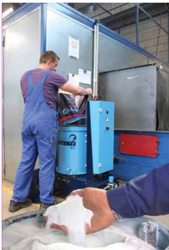
Obr. 5 – Aditivum ve formě prášku se automaticky přidává do tryskací směsi
