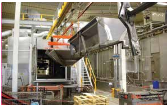
Obr. 1 – Tryskání je standardní proces pro přípravu povrchu
