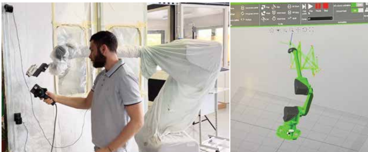
Obr. 2 – Inovativní systém tvorby trajektorie lakýrníkem a následné zobrazení a úprava v software VR Tracking od CMA Robotics
