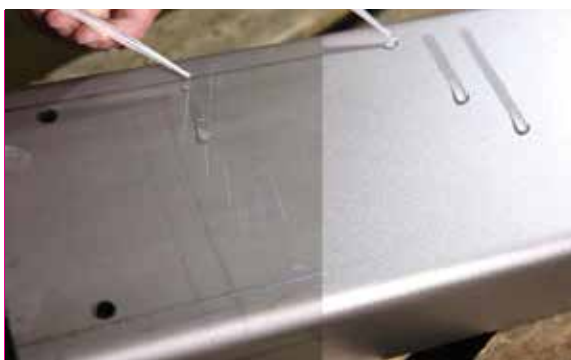
Obr. 2 – Kontrola povrchu – vlevo mastný, vpravo suchý, bez mastnot
