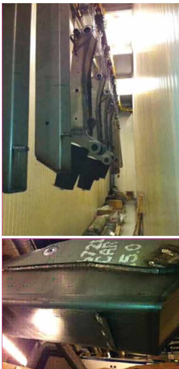
Obr. 7 a 8 – Skutečný stav mastných dílů před začátkem tryskání
