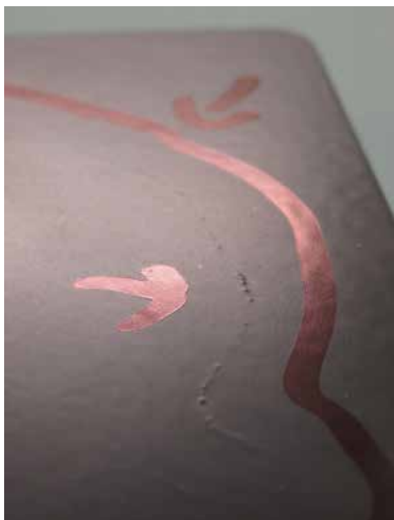
Obr. 1 – Přischlá oplachová voda špatné kvality po zalakování
