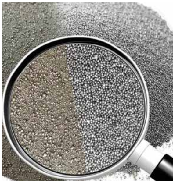
Obr. 12 – Nalevo pracovní směs nepoužitelná v důsledku ucpané filtrace, napravo vyčištěná směs s plným abrazivním účinkem
