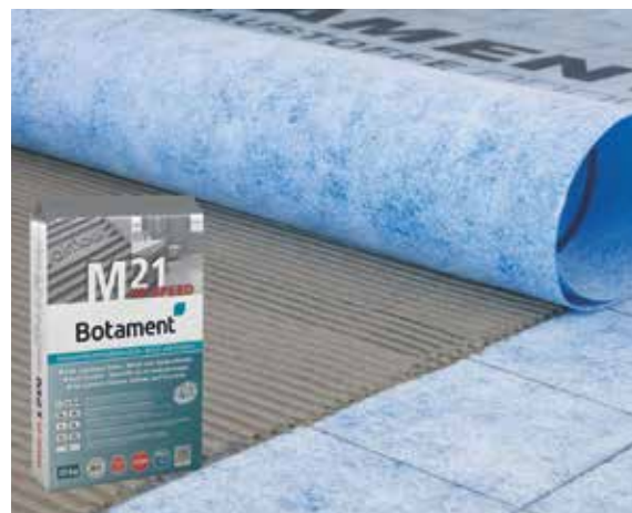
Obr. 4 – Izolační a dělicí fólie AE se ukládá s překrytím 5 cm do lepidla M21 nebo rychleschnoucího M21 HP Speed
