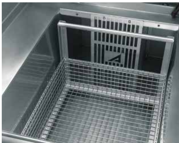
Obr. 2 – Detail koše na díly a krytu míchadla
