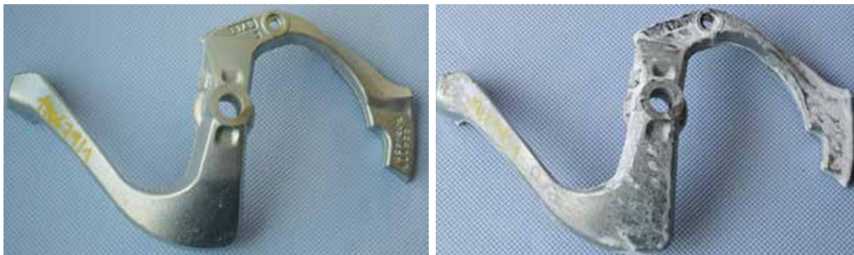
Obr. 2 – Povrchová úprava dle VW 13750, TL217, ofl-c640, silnovrstvá pasivace. Fotografie dílu po 12 hodinách (vlevo) a po 168 hodinách expozice (vpravo) dle ČSN EN ISO 9227, metoda NSS. Výsledek: PÚ vyhovuje požadavkům bez koroze zinku i koroze základního kovu
