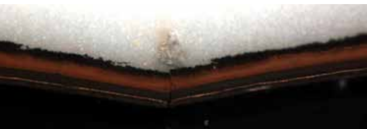
Obr. 2 – Příklad zobrazení řezu vadou, vycházející z vměstku v základním materiálu (ABS). Optická mikroskopie, leptáno, zvětš. 200x, Nomarski
