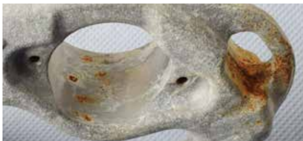
Obr. 3 – Povrchová úprava dle VW 13750, TL244, ofl-c643, ZnNi transparentní pasivace s utěsněním. Fotografie dílu po 4 cyklech korozní cyklické klimatické zkoušky PV 1209. Výsledek: nevyhovuje, přítomna koroze základního kovu (červené koroze) ve velkém rozsahu
