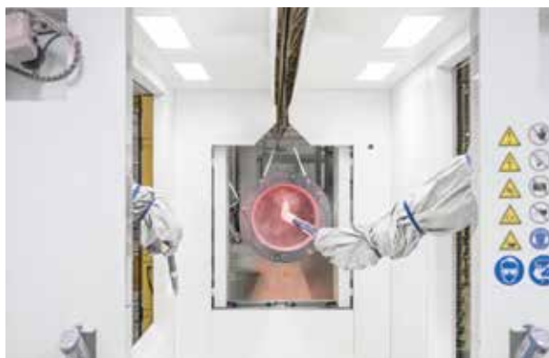
Obr. 2 – Robotické nanášení práškového nátěru uvnitř pouzdra
