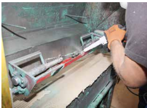
Obr. 3 – Otryskávání lakovací komory
