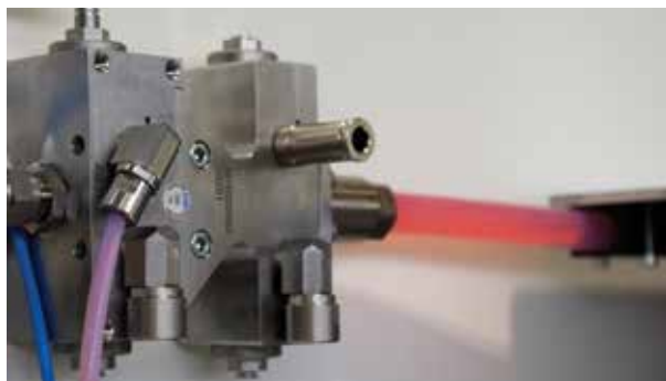
Obr. 3 – Zdrojová stanice je startovním bodem. Materiál vytlačuje pístek ze zdrojové stanice přes distributory až do cílové stanice
