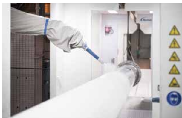
Obr. 3 – Robotické nanášení práškového nátěru vně pouzdra
