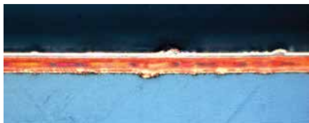
Obr. 4 – Řez vadou, vycházející z nerovnoměrného naleptání základního materiálu (ABS); optická mikroskopie, zvětš. 500x, Nomarski
