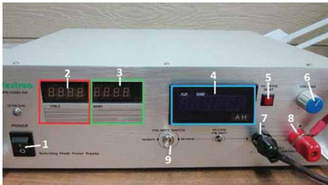
Obr. 3 – Zdroj stejnosměrného proudu
