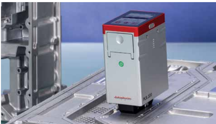
Obr. 2 – Přenosný goniometr PCA 200 nabízí tři možnosti ovládní měření, nastavení parametrů přístroje a pokročilé analýzy výsledků měření
