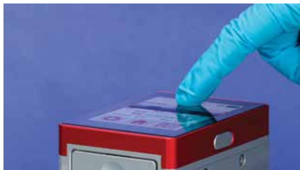
Obr. 2 – Přenosný goniometr PCA 200 nabízí tři možnosti ovládní měření, nastavení parametrů přístroje a pokročilé analýzy výsledků měření
