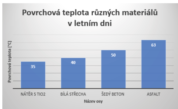
Graf 2 – Typická povrchová teplota v letním dni – rozdíly teplot mezi povrchy s \text{TiO}_2 a běžnými stavebními materiály
